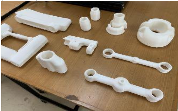
Gambar 4. Komponen prototipe Kruk.
