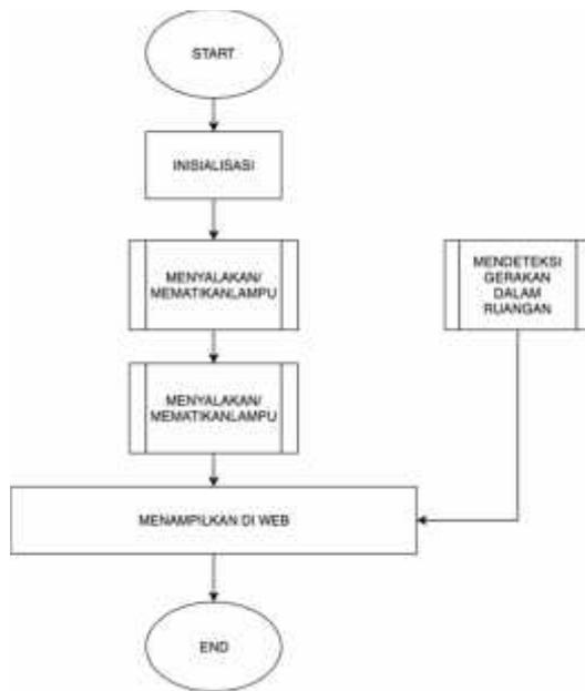
Gambar 5. *Flowchart* Keseluruhan
